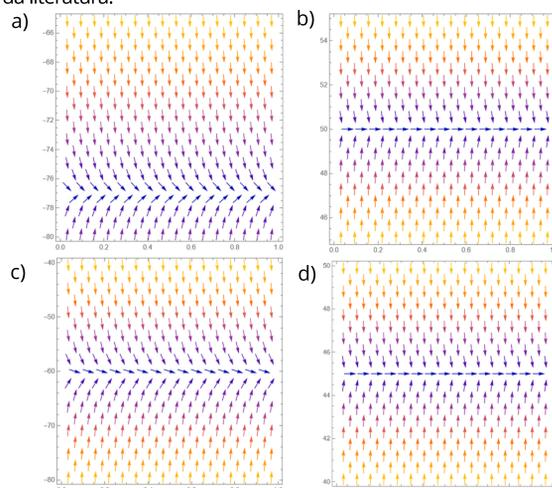
Gráficos de  $dV/dt$  para: a) equilíbrio  $K^+$ ; b) equilíbrio  $Na^+$ ; c) com fluxo  $K^+$ ; d) com fluxo  $Na^+$ .
